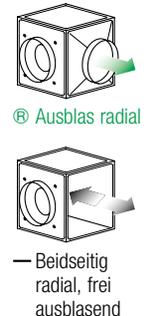
Für die Förderung von verschmutzter, feuchter und heißer Luft bis max. 120 °C. Motor außerhalb des Förderstromes liegend.
